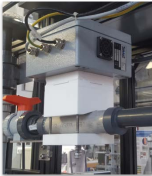
Elektromagnetischer Durchflussmesser EMDtr, Hochtemperatursensor, Messumformer
