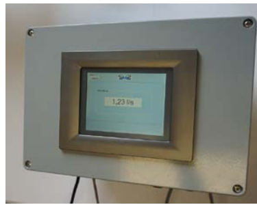
Elektromagnetischer Durchflussmesser EMDtr, Hochtemperatursensor, Messumformer
