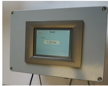
Elektromagnetischer Durchflussmesser EMDtr, Hochtemperatursensor, Messumformer
