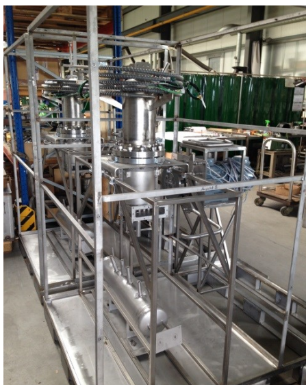
Flüssigmetallkreislauf im Bau in Kooperation mit dem Karlsruher Institut für Technologie
