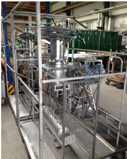
与卡尔斯鲁厄理工学院 (KIT) 合作建造的液态金属循环系统
